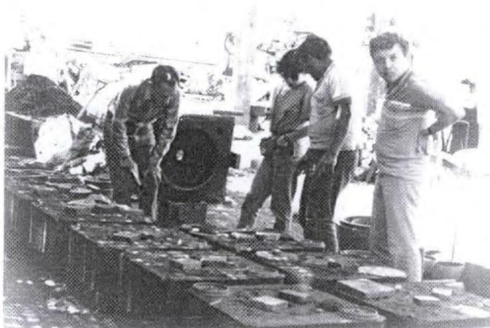
Foto 32: Uso de la arena sílicea en el desmolde de autopartes, Balanzas Trujillo, 1991, cortesía A. Díaz
