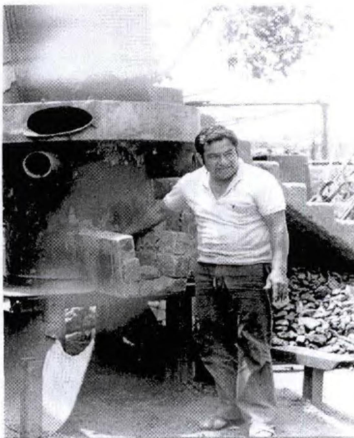
Foto 33: Horno para fundir metales revestido de ladrillos refractarios- Trujillo, 1991 cortesía A. Díaz
