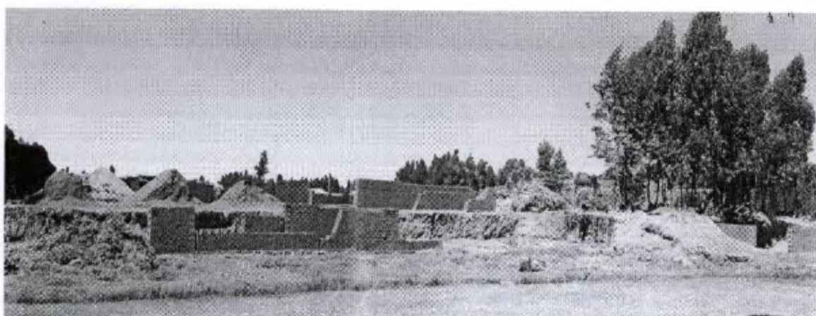
Foto 26 Cantera Chacina (Arcillas). Vista Panorámica de los hornos artesanales donde queman ladrillos, también se puede apreciar el producto listo para ser cocido en los hornos. Franja N° 04. Cuadrángulo de Jauja. Departamento de Junín.
