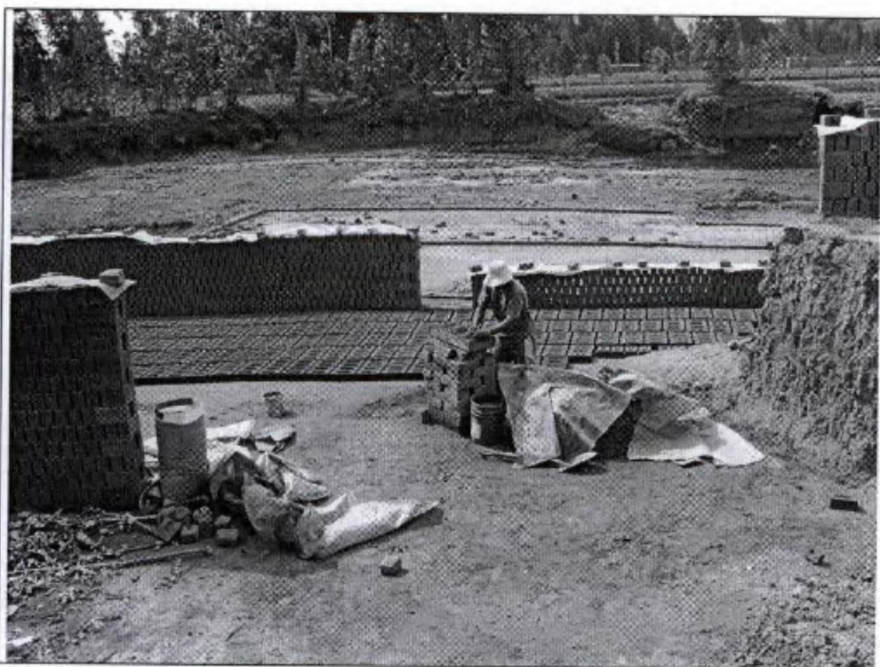
Foto 16 Actividad ladrillera Cajas – Huancayo – Junín – Noviembre 2005 Utilización de moldes de madera para la fabricación de ladrillos
